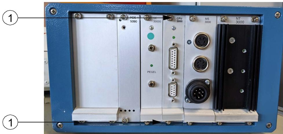
Die montierte CPU wird wieder in das Steuergerät eingesetzt und mit den zwei Schrauben (1) verschraubt.
