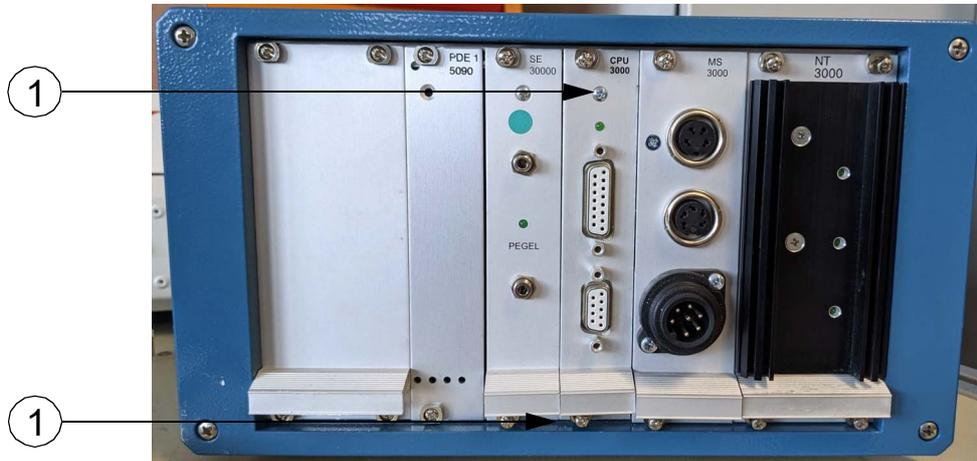
Um die CPU herausnehmen zu können müssen die zwei Schrauben (1) mit einem Kreuzschlitz Schraubendreher heraus gedreht werden.
