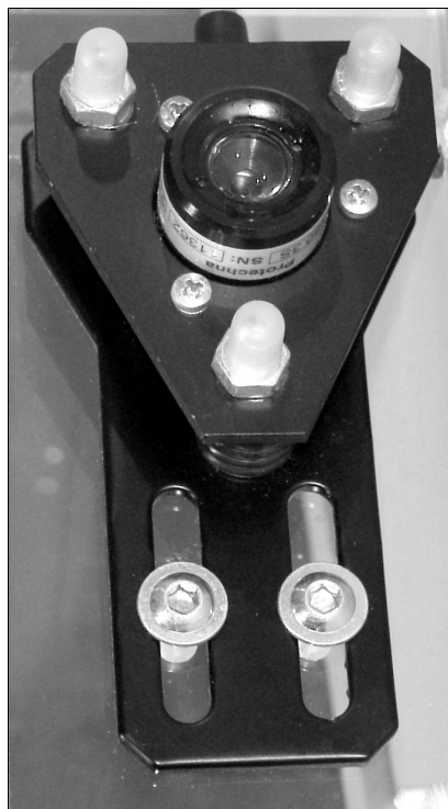
Emisor láser 480 (Control a la entrada del hilo / carcasa de color negro)
