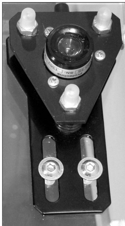
Émetteur laser 480 (Contrôle au niveau de l'alimentation fils / couleur du boîtier noire)
