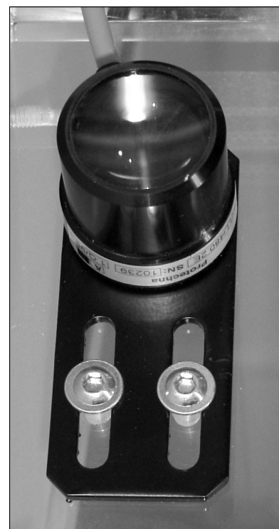
Récepteur 480 Pour le contrôle du niveau d'alimentation du fil et du contrôle du fil de trame
