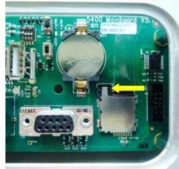
Die SD-Karte wird automatisch vom Kartenhalter freigegeben und springt ein wenig heraus. Verwenden Sie den an der SD-Karte angebrachten Plastikstreifen, um die Karte vollständig zu entfernen. Setzen Sie die neue Karte in den Halter ein und drücken Sie die Karte hinein, bis der Entriegelungsknopf zurückspringt und die SD-Karte verriegelt.
