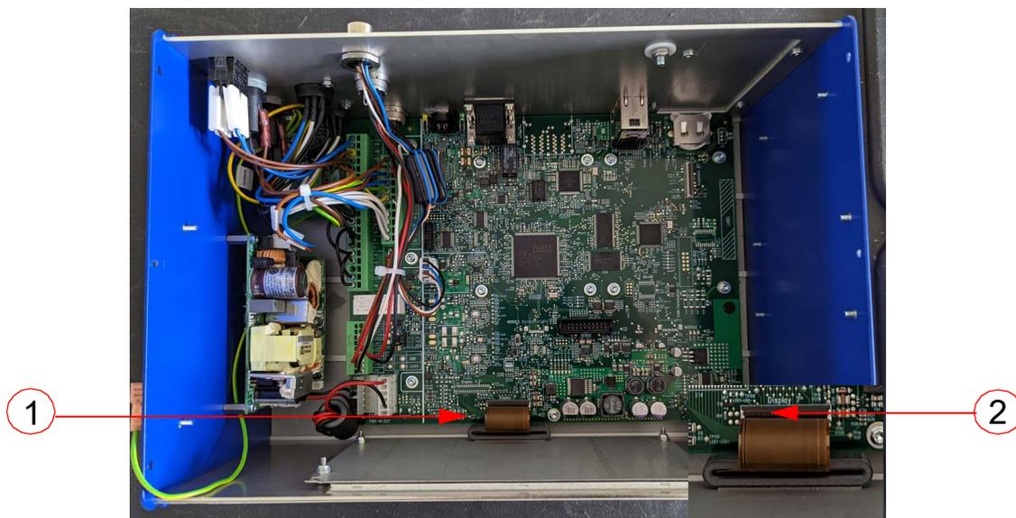
In diesem Schritt muss das Flachfolienkabel des Displays (15122) (1) abgesteckt werden. Hierzu muss die Verriegelung des Steckverbinders (2) geöffnet werden. Anschließend kann das Flachfolienkabel (1) vorsichtig senkrecht aus dem Steckverbinder (2) gezogen werden.
