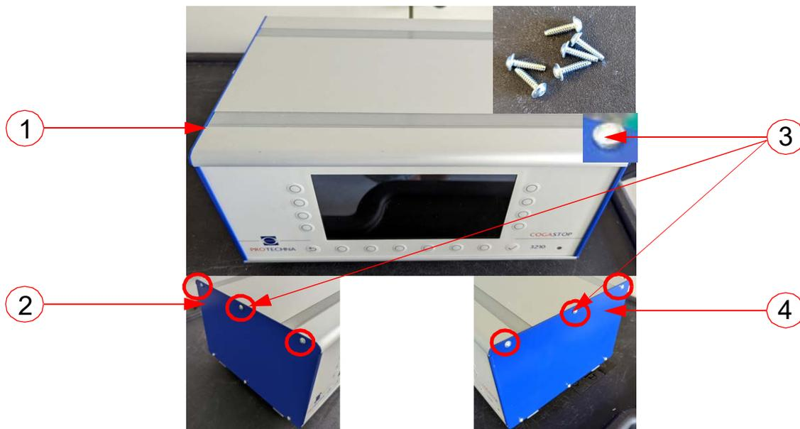
Lösen Sie die drei oberen Schrauben (13438) (2) der Seitenwand-links (14063) sowie die drei oberen Schrauben (13438) (4) der Seitenwand-rechts (14062) des Steuergeräts. Achtung: mittlere Schraube ist mit einer Kontaktscheibe M3 (11618) (3) befestigt. Nachfolgend kann der Gehäuseprofil Deckel (13461) (1) vom Steuergerät entfernt werden.
