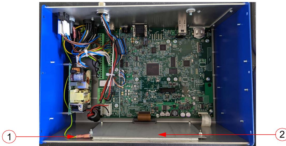
Entfernen Sie das Erdungskabel (1) vom Display (15122) (2).
