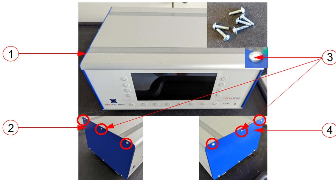
Legen Sie den Gehäuseprofil Deckel (13461) (1) auf das Steuergerät. Nachfolgend wird der Gehäuseprofil Deckel (13461) (1) mit drei Schrauben (13438) (2) an der Seitenwand-links (14063) sowie mit drei Schrauben (13438) (4) an der Seitenwand-rechts (14062) fixiert. Achtung: mittlere Schraube ist mit einer Kontaktscheibe M3 (11618) (3).
